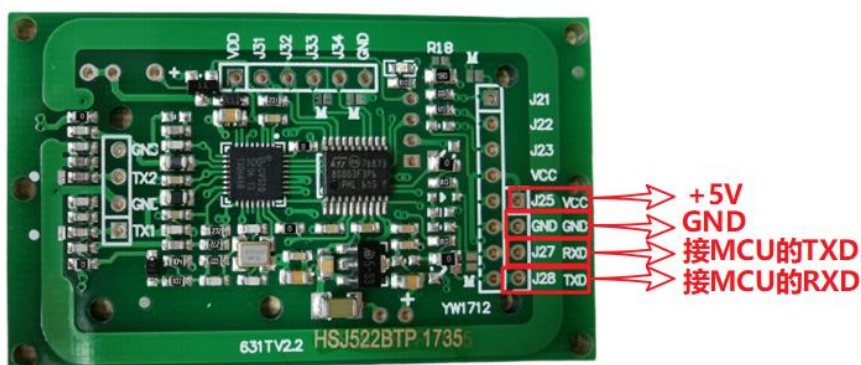
图 4.1 HSJ522B 模块与 MCU 接法
